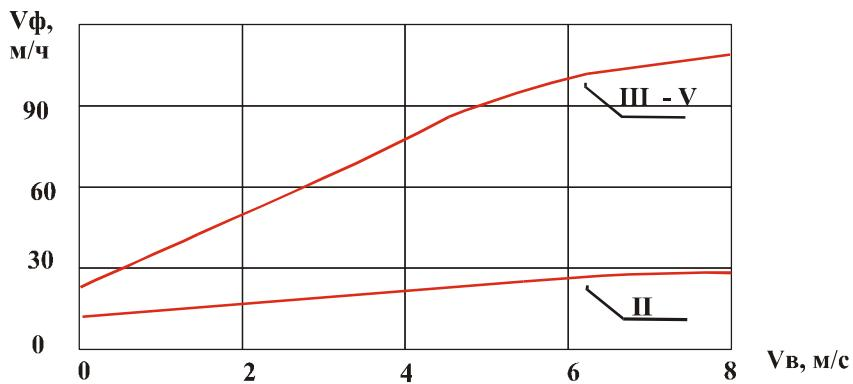
А.  $V_{\phi}$  – скорость распространения фронта пожара.
