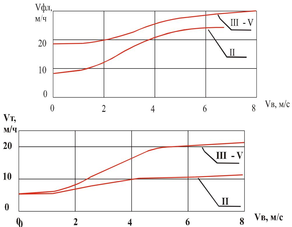
Б.  $V_{\text{фл}}$  - скорость распространения фланга пожара.
