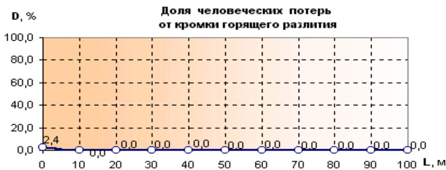
Рис. Доля человеческих потерь при воздействии теплового потока от кромки горящего разлия
