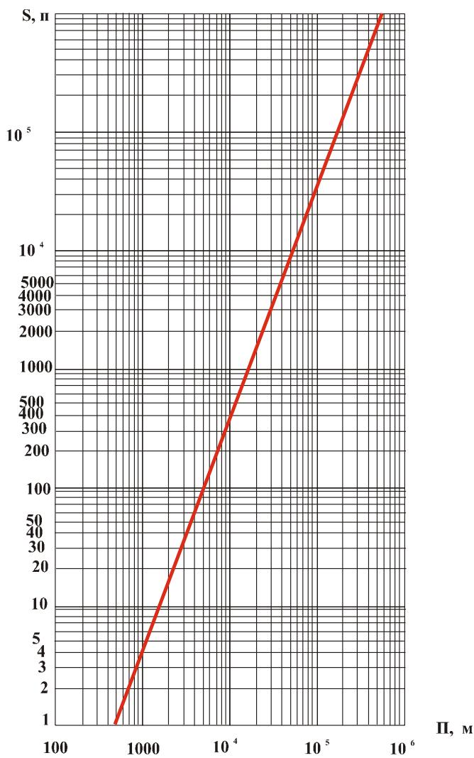
Рис. 5.3. Определение приращения периметра площади пожара  $S$ .
