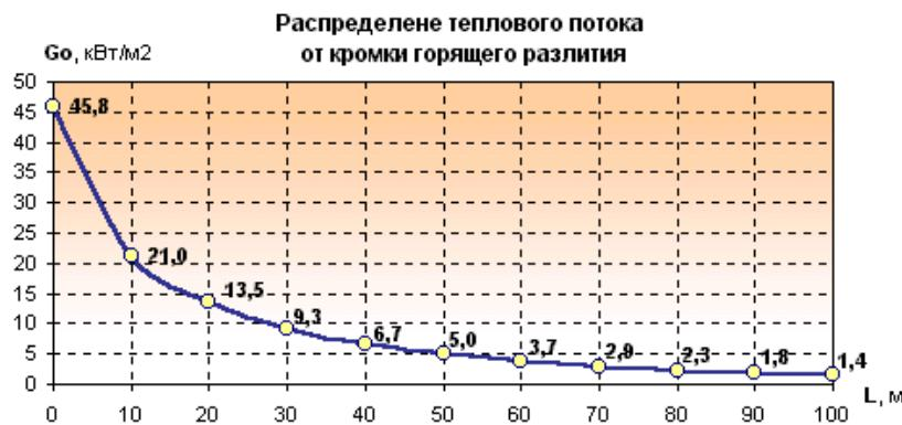
Рис. Величина теплового потока от кромки горящего разлия
